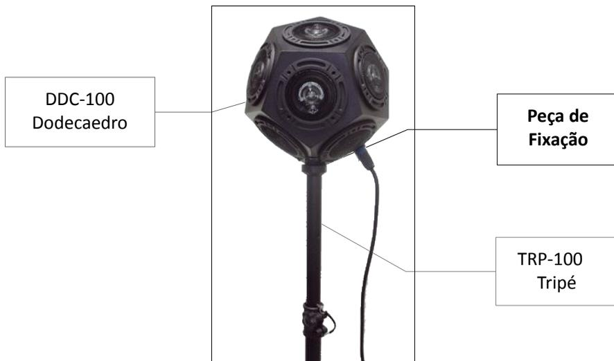
Figura 5: Encaixe do DDC-100 no Tripé
